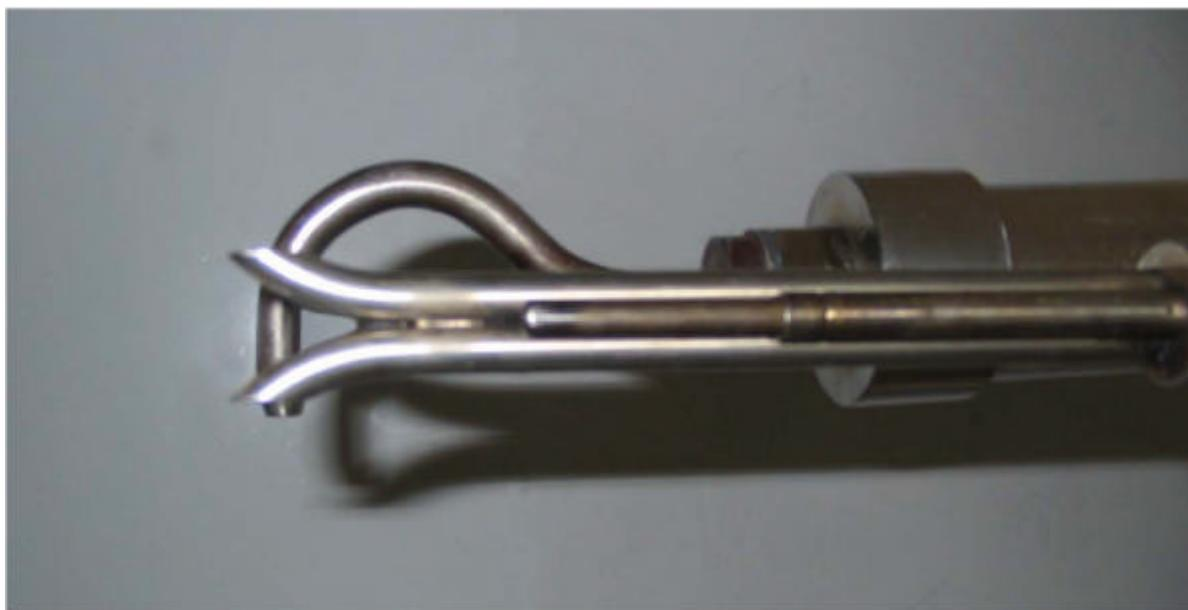
Fig. 5): tubo di Pitot tipo S, in combinazione con termocoppia e sonda di prelievo.
